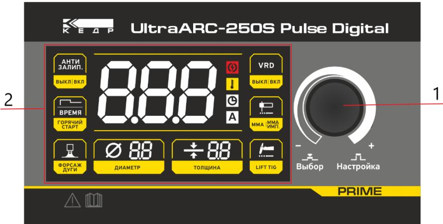
1. Энкодер: осуществляет переключение режимов сварки ММА / ММА ИМПУЛЬС. / LiftTIG. При кратковременном нажатии энкодер осуществляет выбор или переключение между дополнительными функциями. При выборе функции индикация начинает мерцать, в этот момент функцию можно настроить, включить или выключить.
